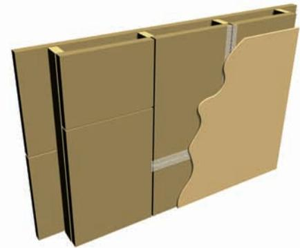
Lehmbauplatten als Trockenbauplatten
